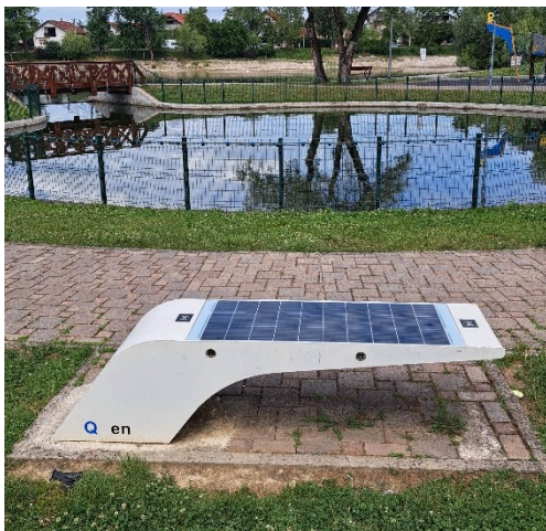
Slika 6.17. Fotonaponski punjiva klupica s USB punjačem, park Kipišće (Snimio: UIH d.o.o.)
